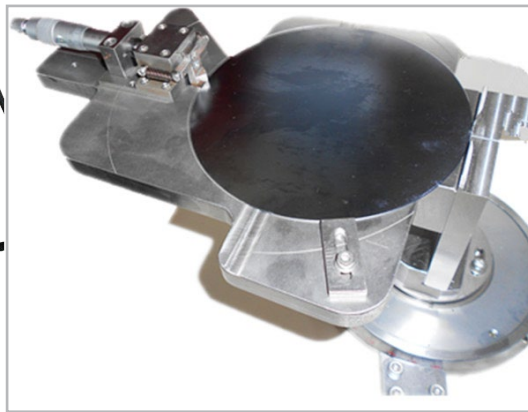
インゴットの端面とエッジを測定
