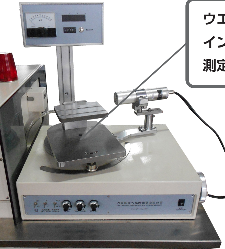
ウエハーの notch 角度を測定
